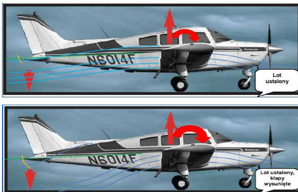
Rys. 4. Wpływ klapy na oblodzenie usterzeń
